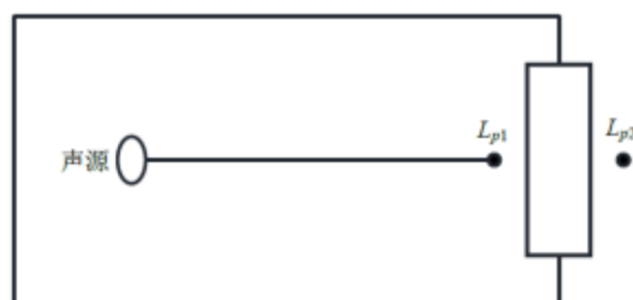
图 4-3 室内声源等效为室外声源图例
