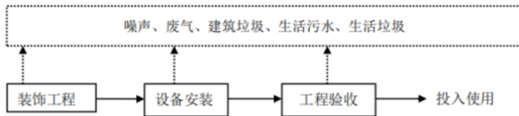
图 2-2 项目施工期工艺流程及产污位置示意图
